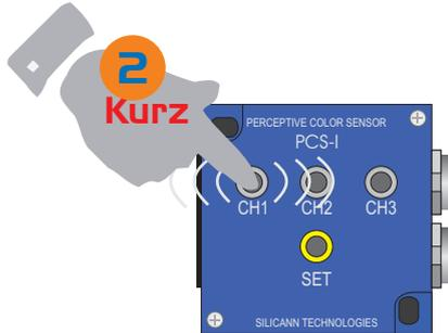
2 **Kurz** Toleranz für Farbkanal 1 durch mehrfaches kurzes Drücken einstellen
