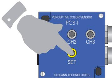
3 SET Taste für das Speichern der Toleranzen und das Verlassen des Programmiermodus drücken
